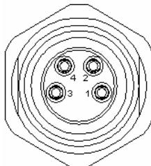
图 2-7. M8 4Pin 连接器 (X8: A/X8: B)
