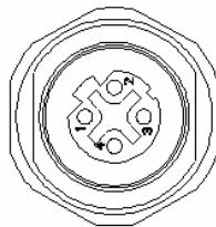
图 2-6. LAN-M12 连接器 (X6: LAN1/X7: LAN2)
